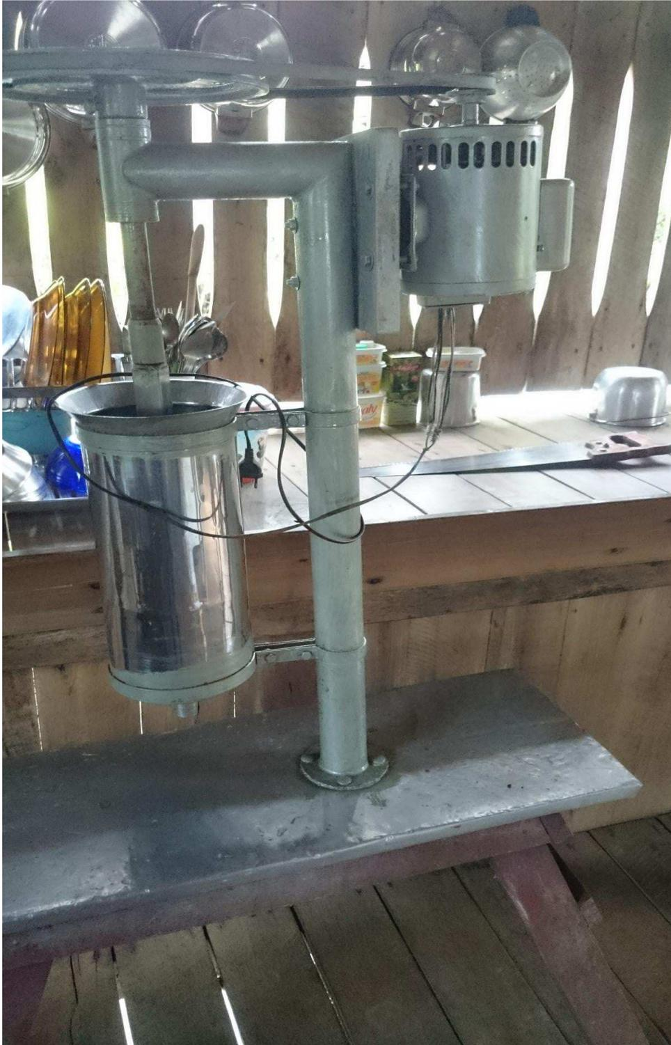
**Figura 35:**Máquina de produzir açai
